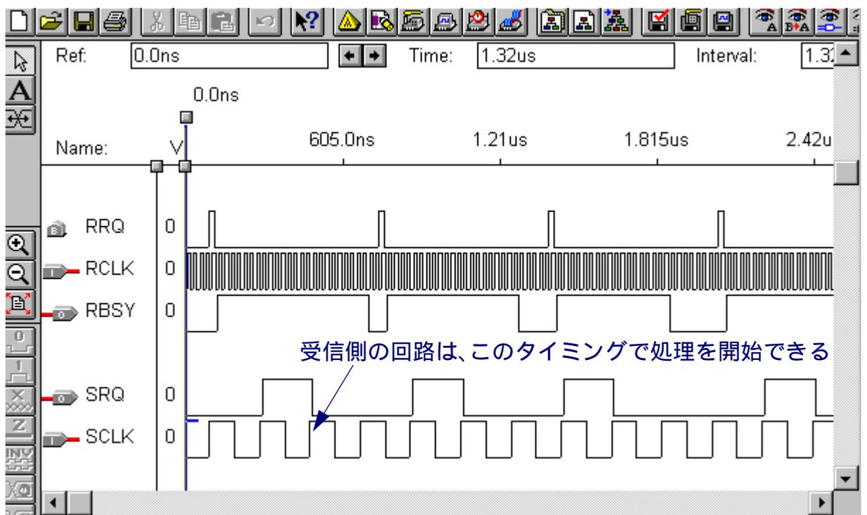
RCLK 回路からの4つのパルスが、SCLK 回路に4つ伝達されており、ビジー信号が外部の回路に調停タイミングを送っています。
